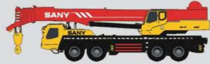
STC75 最大额定起重量: 75t 主臂: 5节臂, 11.8~45m 底盘: 8×4×4
